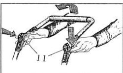
**Montage Verdeckbezug:** Der Verdeckbezug wird mit einem Reißverschluss über den Verdeckbügel befestigt. Achten Sie bitte darauf, daß die aufstellbare Rücklehne hinten und der rote Bedienknopf vom Verdeckbügel rechts der Wanne ist. Schließen Sie den Reißverschluss vorsichtig !
